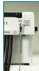
Abb. 3: Stecker für den automatischen Rotationsstop
